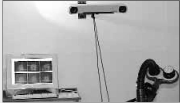
Illustration 2. Stimulation magnétique transcrânienne couplée à un système de neuro-navigation : la bobine de stimulation magnétique avec son système de refroidissement par air est à droite. Le système de neuro-navigation comprend une caméra infra-rouge (en haut) et un ordinateur présentant la position de la bobine par rapport à la région cible (à gauche). La caméra suit le déplacement de boules réfléchissant les infra-rouges positionnées sur le patient et sur la bobine (l'une d'entre elle est visible près du manche).
