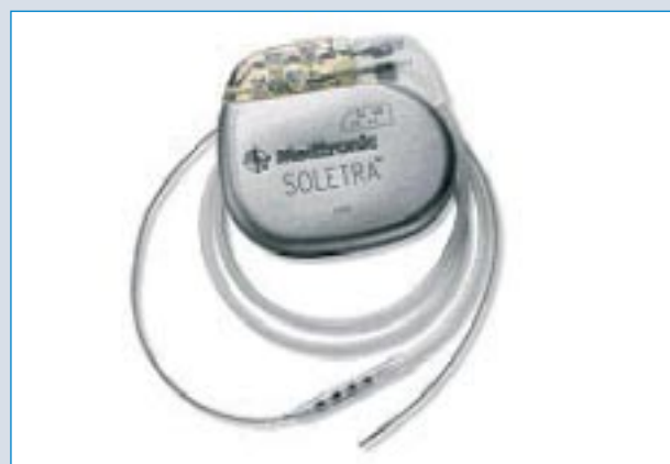
Figure 1: Exemple d'un stimulateur intracrânien (Soletra® et faisceau d'électrodes implantable, Medtronic Inc, Minneapolis, Minnesota, USA).
